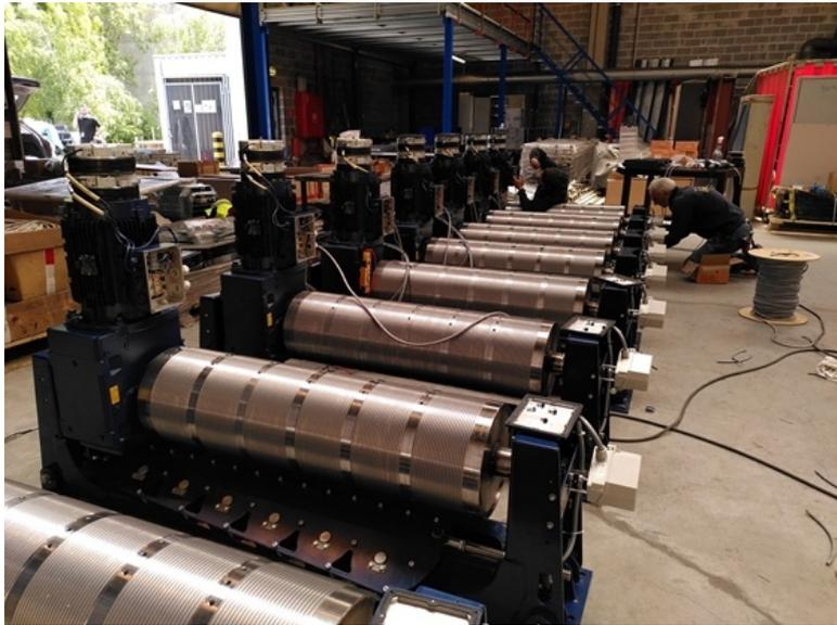
Diverses charges, telles que des toiles, des décors, des éclairages, des écrans et du matériel audio, peuvent être suspendues à un cintre, au-dessus de la scène ou dans la salle. À l'AB, ces charges étaient hissées manuellement, à l'aide de contrepoids. Les cordes, les roues et les câbles nécessaires font monter et descendre les porteuses (tubes), dotées de leurs charges. Il s'agit d'un travail pénible. Ce constat ne surprendra, sans doute, personne.
